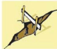
在裂缝两侧设立标杆
