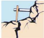
在裂缝壁上安装标尺
